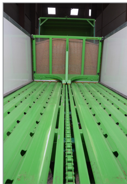
DRAKKAR CATENA® - podczas wyładunku tańców wspomaganie podwaja siłę przenoszącą ładunek, który jest doskonale widoczny dzięki ściance z pleksiglasu
